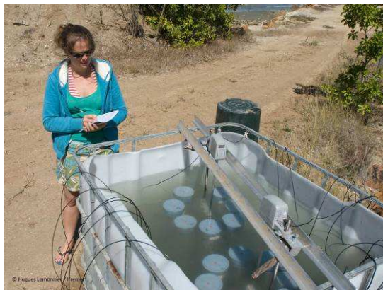
Figure 18: Système mis en place pour la mesure du métabolisme dans des carottes de sédiment prélevées en milieu côtier dans le cadre du projet Hobical - Réalisation S. Hochard
