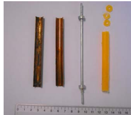
photo 1 : moule pour fabriquer les bagues oculaires en silicone
