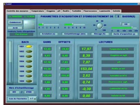
Fig. 4 : Face avant du logiciel de contrôle
